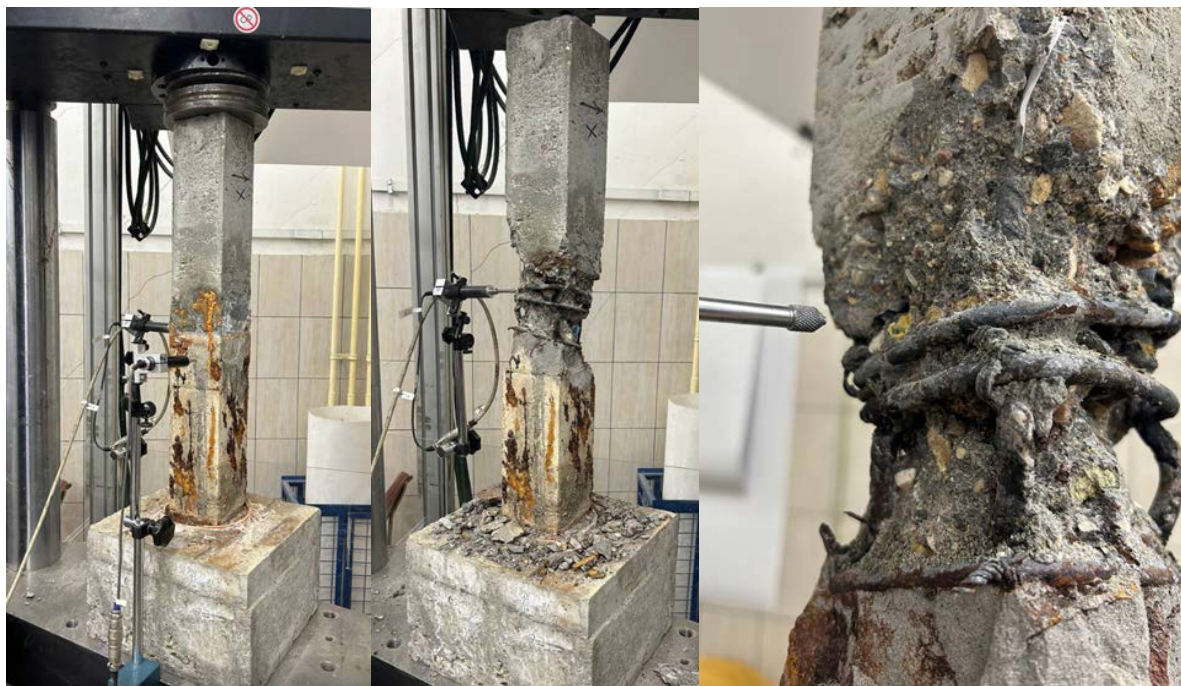
Рис. 4. Разрушение колонны с коррозией
