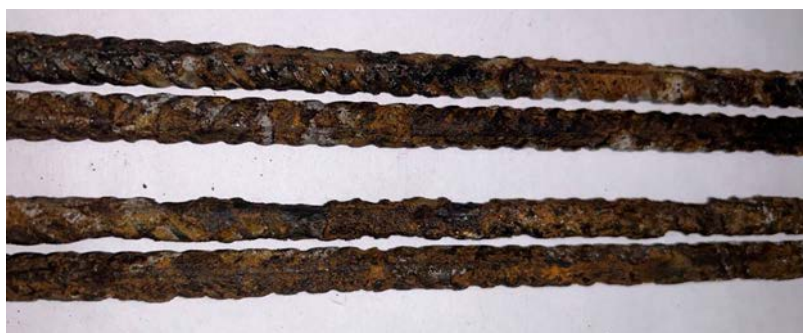
Рис. 3. Изменения диаметра арматуры при коррозии
