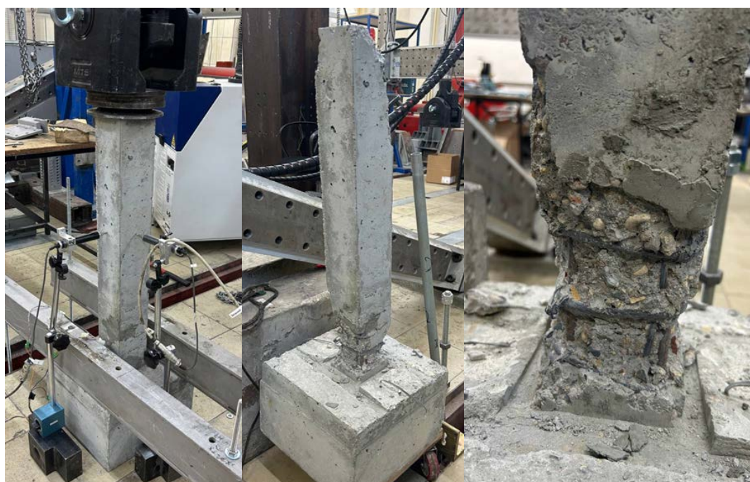
Рис. 5. Разрушение колонны без коррозии
