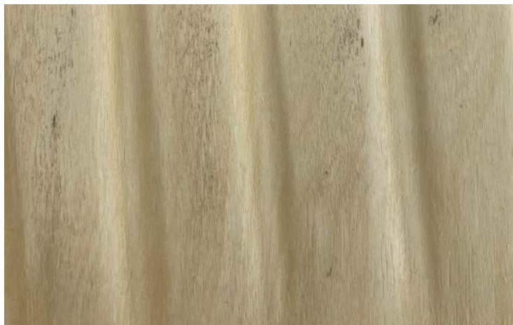
Рис. 4. Поверхность образца, полученного с продольным направлением волокон и расстоянием между стержнями 32 мм
