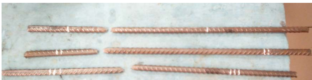
Рис. 2. Образцы арматурного проката без сварных швов после испытаний на прочность
